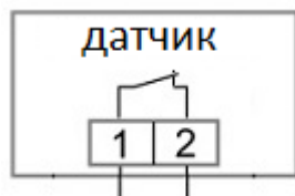
Рисунок 2б. Схема подключения ДГА -03 (контакт 1 и 2 размыкаются под действием магнита)
