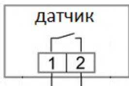
Рисунок 2а. Схема подключения ДГА -02 (контакты 1 и 2 замыкаются под действием магнита)
