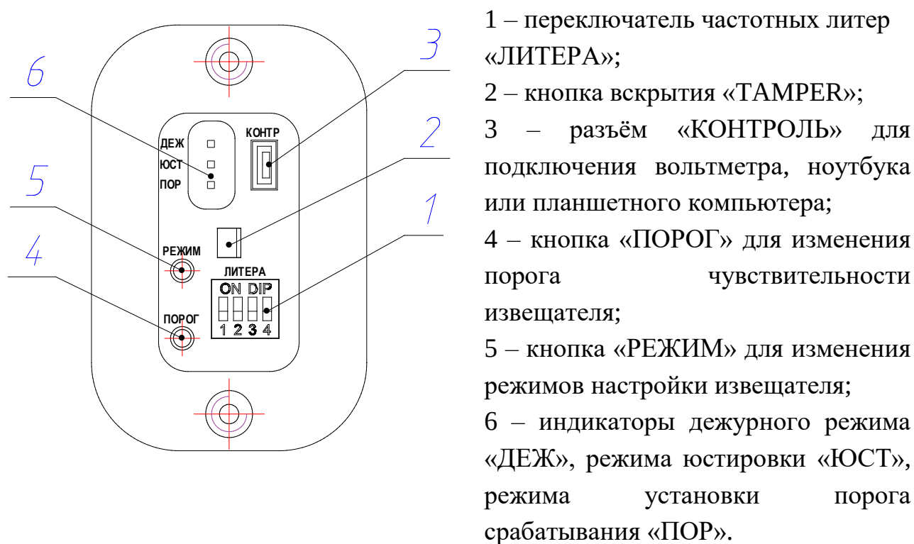
Рисунок 1.9 – Органы настройки блока ПРМ извещателей «ФОРТЕЗА» (исполнения «Ethernet»)
