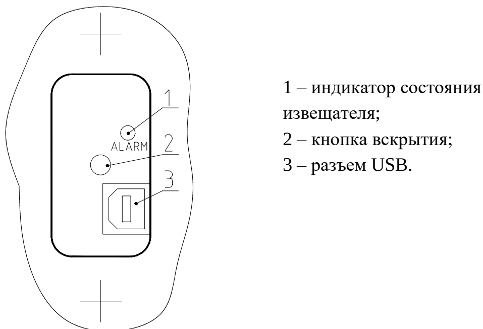
Рисунок 1.3 – Органы настройки блока ПРМ-ПРД извещателей «ЗЕБРА-42(24)»
