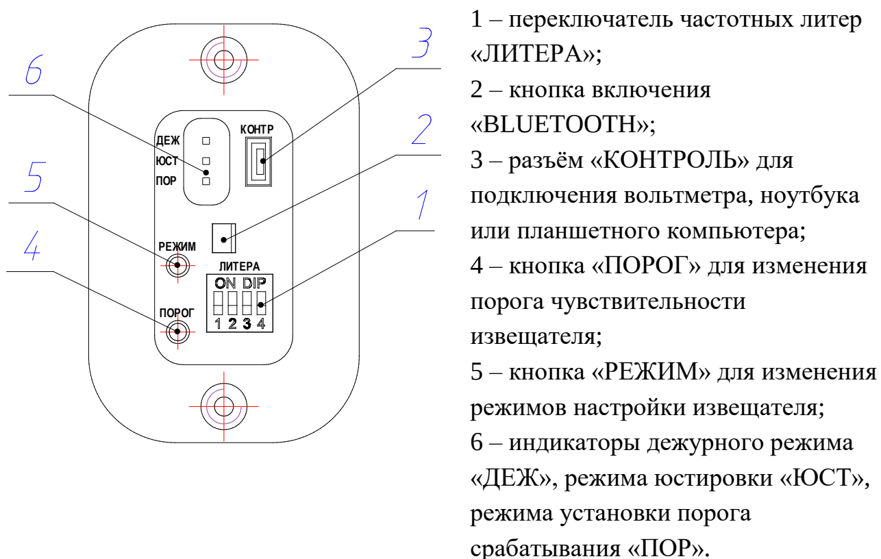
Рисунок 1.9 – Органы настройки блока ПРМ извещателей «ФОРТЕЗА» (исполнение «bluetooth»)
