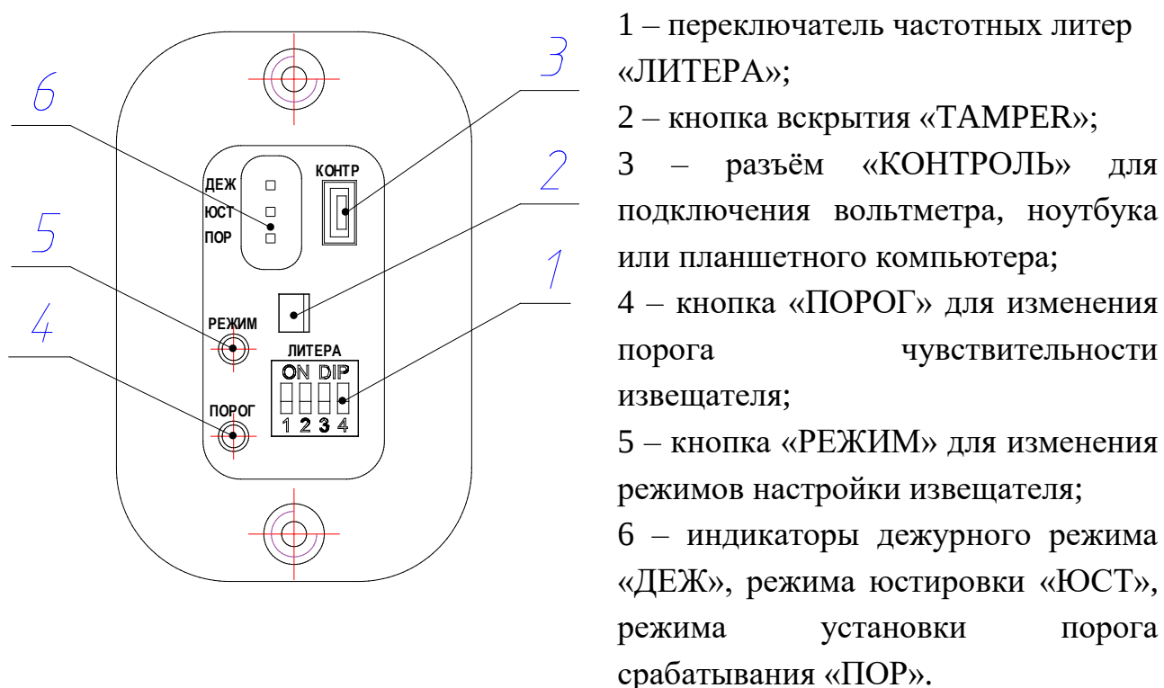
Рисунок 1.9 – Органы настройки блока ПРМ извещателей «ФОРТЕЗА» (исполнение «А»)
