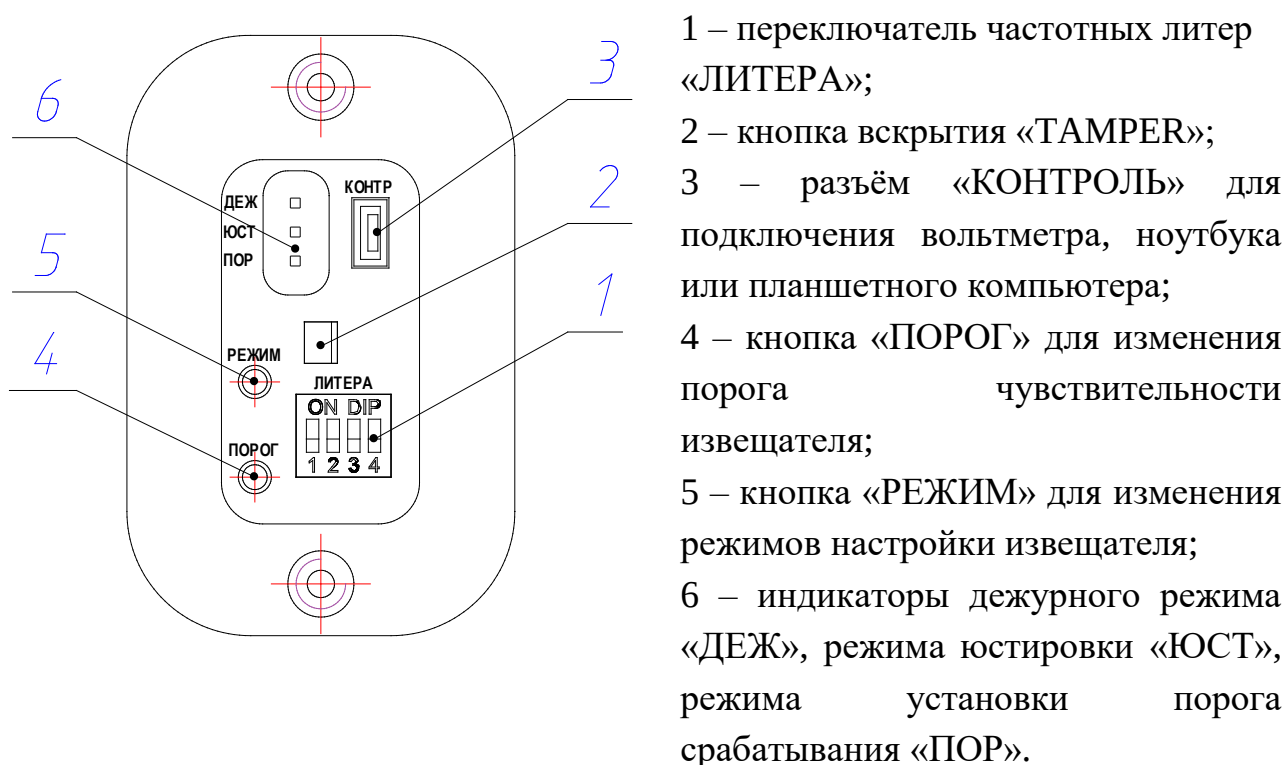
Рисунок 1.9 – Органы настройки блока ПРМ извещателей «ФОРТЕЗА» (общего назначения)
