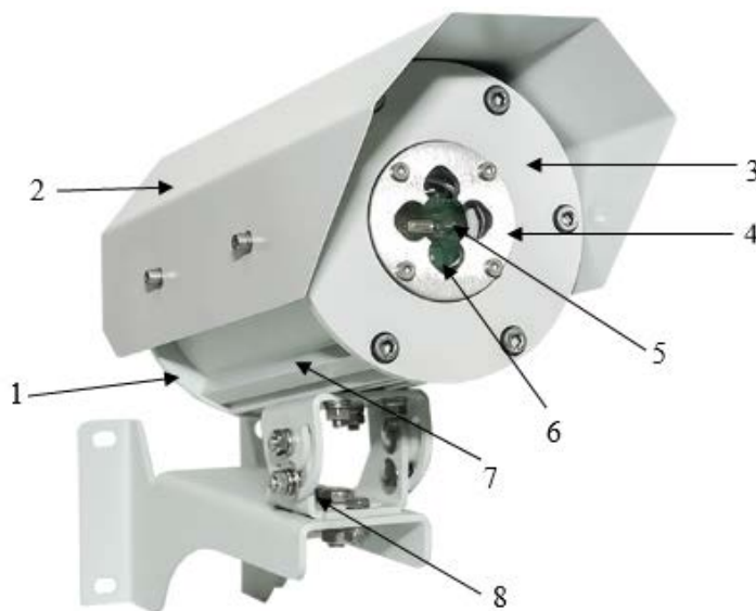
1 – основание с кабельными вводами; 2 – солнцезащитный козырек; 3 – лицевая панель; 4 – защитная решетка; 5 – смотровое окно; 6 – индикатор состояния; 7 – корпус извещателя; 8 – крепежно-юстировочное устройство.
