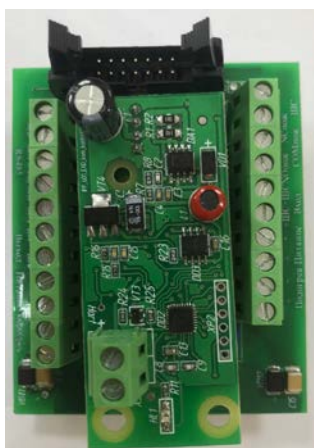
Рисунок 4 – Клеммная плата извещателя
