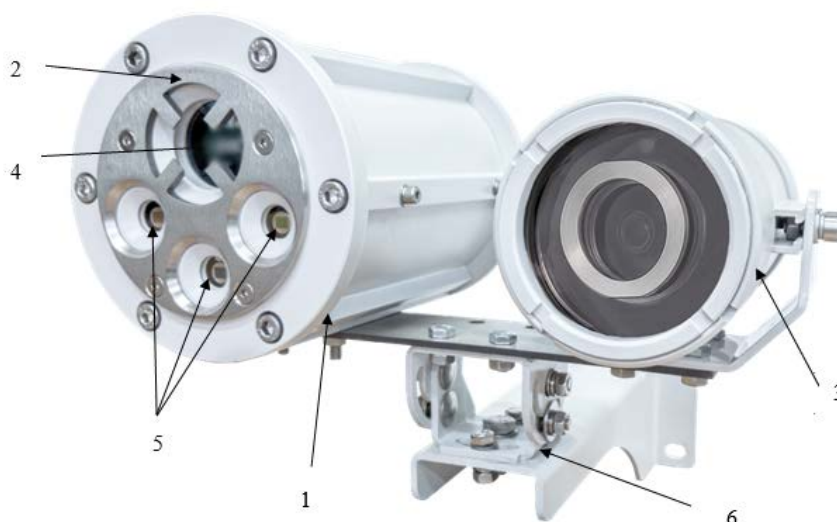
1 – корпус извещателя; 2 – место поднесения магнита; 3 – корпус видеомодуля; 4 – светодиодный индикатор; 5 – приемник ИК-излучения; 6 – крепежно-юстировочный кронштейн.
