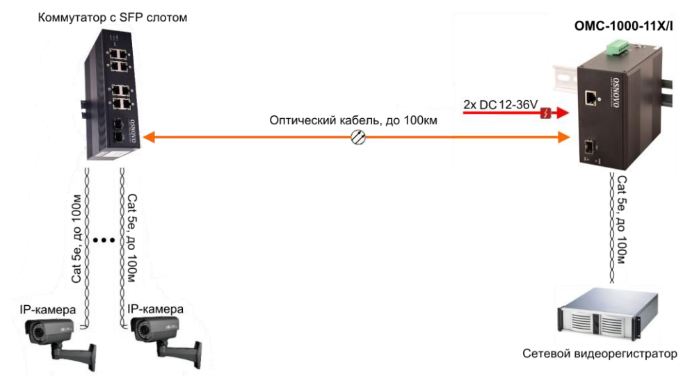
Рис.4 Типовая схема подключения медиаконвертера OMC-1000-11X/I
