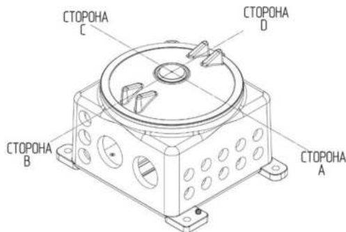
Рис. 2. Схема расположения отверстий под установку кабельных вводов в корпусе серии КВМК, СМД МК, моделей: КВМК 2.1 Exd-A-XXX... X, КВМК 2.1 Exd-H-XXX... X, КВМК 2.3 Exd-A-XXX... X, КВМК 2.3 Exd-H-XXX... X, СМД МК 2.1 Exd-A-XXX... X, СМД МК 2.1 Exd-H-XXX... X, СМД МК 2.3 Exd-A-XXX... X, СМД МК 2.3 Exd-H-XXX... X.
