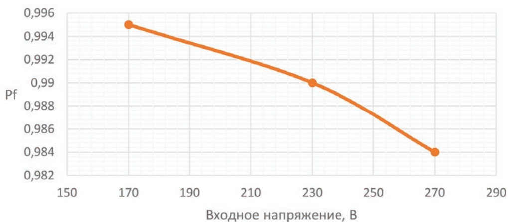
Рис. 4. Зависимость коэффициента мощности ( P_f ) от входного напряжения
