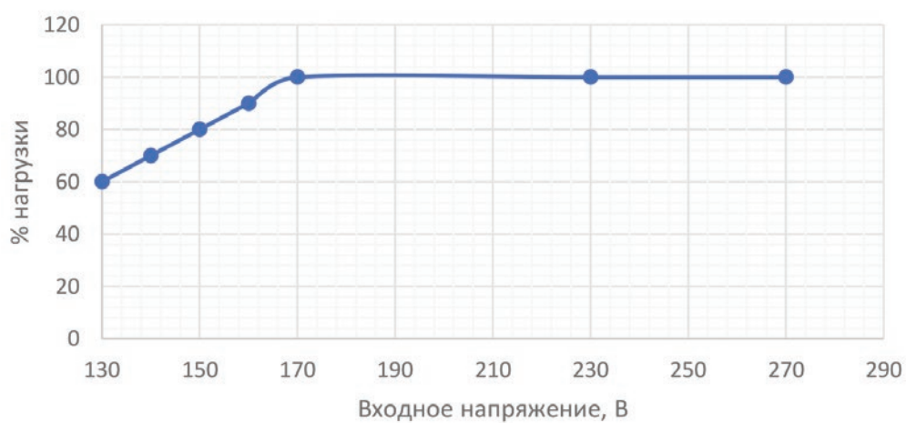
Рис. 6. Зависимость мощности нагрузки от входного напряжения
