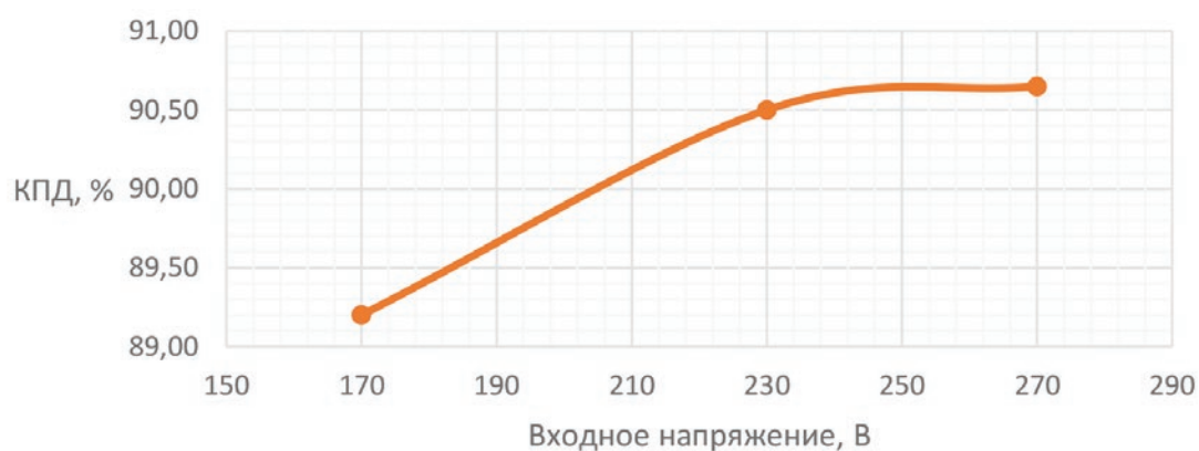
Рис. 1. График зависимости КПД от входного напряжения
