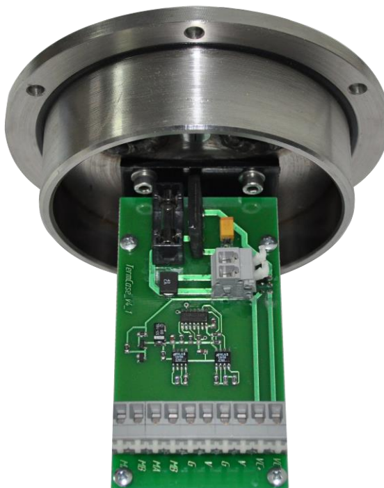
Рисунок 5 – Клеммная плата термокожуха
