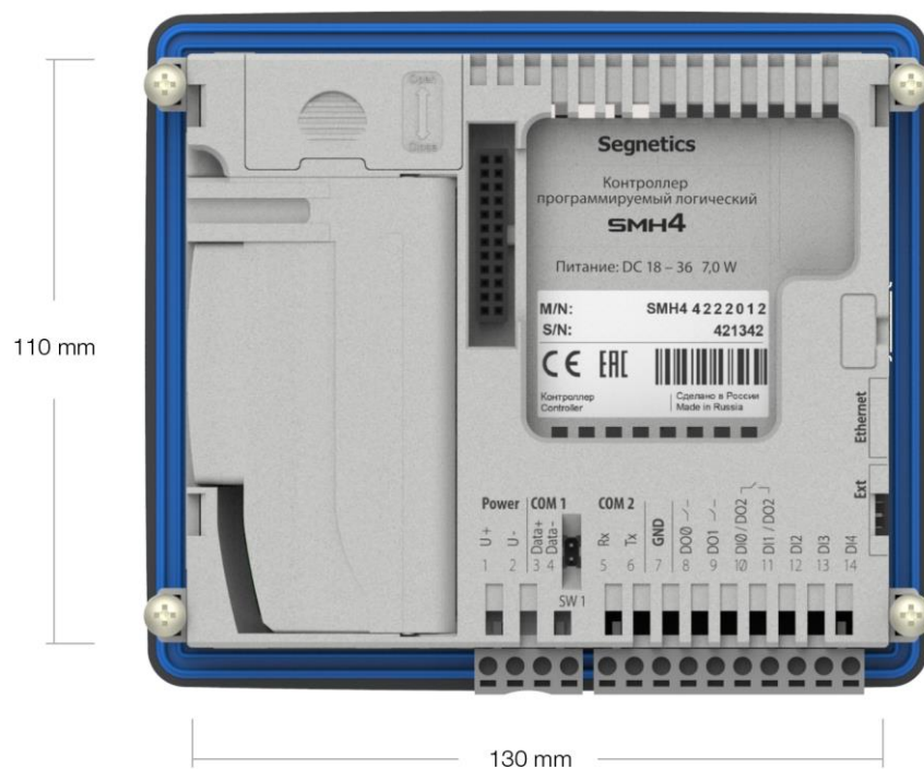
Рис. 7 – Установочные размеры контроллера
