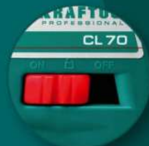
Кнопка блокировки фиксирует компенсатор при транспортировке
