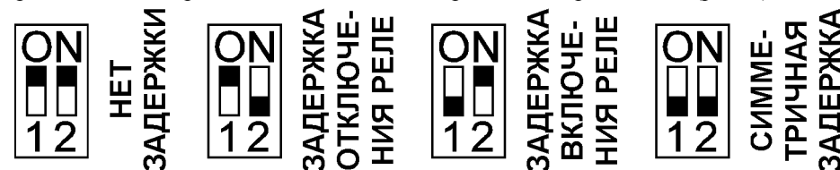
Рис. 4. Внутренние переключатели датчика РДД-02.
